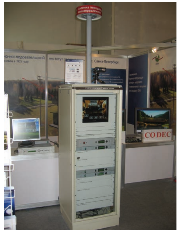
Многофункциональная приемно-передающая станция DVB на стенде НИИТ
