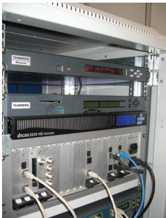
Головная станция Arrear TV, кодер MPEG-4 и оборудование Tanberg компании dicas в стойке на стенде "Контур-М"
