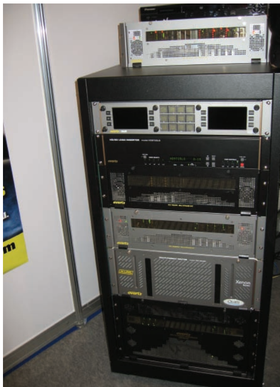
На стенде Evertz: комплекс оборудования, предназначенного для коммутации, конвертации и мониторинга видеосигналов
